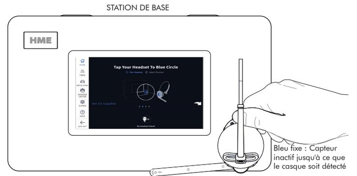
**Remarque :** Si l'appariement échoue (indiqué par un anneau rouge tourbillonnant), essayez à nouveau. Gardez le casque d'écoute bien centré et aligné sur l'anneau d'appariement du casque d'écoute (le mouvement du casque d'écoute et sa distance par rapport à l'anneau d'appariement peuvent provoquer des erreurs d'appariement). L'écran d'appariement ci-dessus n'a pas besoin d'être visible pour coupler un casque d'écoute.
