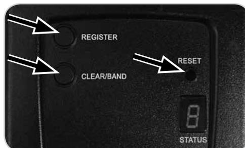
➤ Ein vertikaler Balken erscheint auf der STATUS-Anzeige für den Einkanalbetrieb.
