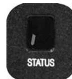
➤ Zwei vertikale Balken erscheinen auf der STATUS-Anzeige für den Zweikanalbetrieb.
