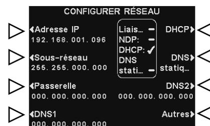
**1. DHCP** permet à la base d'acquérir automatiquement ses paramètres réseau à partir d'un serveur DHCP installé sur le réseau local.
