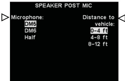
スピーカー・ポストに取り付けるマイクのタイプを選択するには、希望するマイクがハイライトされるまで Microphone(マイクロфон)ボタンを押します。ドライブスルーレーンでのマイクと車両の間の距離を選択するには、適切な距離がハイライトされるまで Distance to vehicle(車両までの距離)ボタンを押します。
