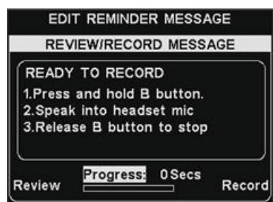
画面の **READY TO RECORD**(録音の準備)の指示に従います。ヘッドセットの B ボタンに触れ続けると、最高 10 秒間のメッセージを録音できます。Progress(プログレス)インジケーターが録音の残り時間を示します。録音を終了するときは、B ボタンを離し、画面の **Review**(確認)ボタンを押し、**READY TO REVIEW**(確認の準備)画面の指示に従い、録音が正しく行われたかを確認します。
