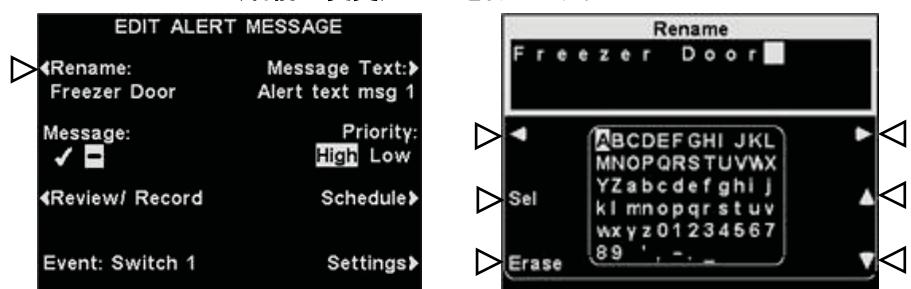
**RENAME(名前変更)** 画面で、**Erase(消去)** ボタンを押し、変更したい名前の文字を消去します。◀(左)、▶(右)、▲(上)、▼(下) ボタンを使用し、名前に使用したい文字にハイライト表示を移動します。**Sel(選択)** ボタンを押してハイライトされている文字を名前として入力します。入力が完了したら、**Back(戻る)** ボタンを押して新しい名前を保存します。
