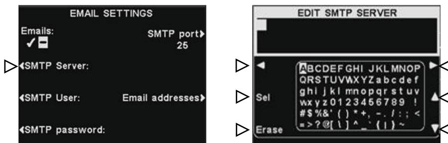
SMTP サーバー名を入力、あるいは変更するには、EMAIL SETTINGGS(メールの設定)画面で SMTP Server(SMTP サーバー)ボタンを押します。変更したい現在の名称の文字を Erase(消去)ボタンを使用し消去します。◀(左)、▶(右)、▲(上)、▼(下)ボタンを使用し、新しい名称に使用したい文字にハイライト表示を移動し、Sel(選択)ボタンを押して上のハイライトボックスに入力します。名称入力が終了したら、Back(戻る)ボタンを押し、名称を保存します。
