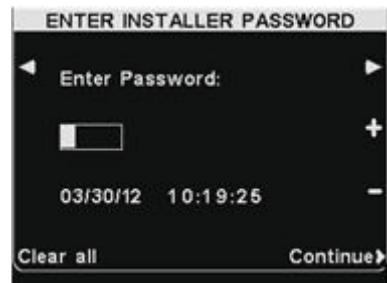
**Enter Password(パスワードの入力)**フィールド内のハイライト表示のボックスに 4 衝の最初の文字を入力するため、+ボタンでアルファベットを、-ボタンで数字を入力します。▶(右)ボタンを押し、次の文字入力のため、ハイライトボックスを右側に移動します。4 衝のパスワードを入力するため、この操作を繰り返します。すべての文字を入力したら、**Installer setup(インストーラの設定)**画面にアクセスするため、**Continue(継続)**ボタンを押します。
