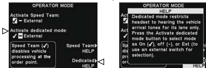
**OPERATOR MODE(オペレータモード)**画面で、**Activate dedicated mode(専用モードの有効化)**ボタンを押し、**✓ (オン)**を選択します。通常モードに戻るには、**- (オフ)**を選択しなければなりません。**Dedicated HELP(専用モードヘルプ)**ボタンをおすと、追加の説明が表示されます。(英語)
