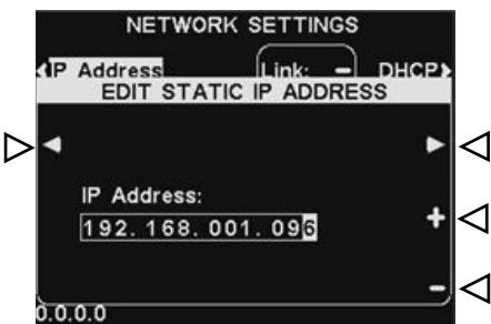
この設定を変更するには、IP Address(IP アドレス)ボタンを押し、EDIT STATIC IP ADDRESS(静的 IP アドレスの編集)画面で、◀(左)または▶(右)ボタンを使用し、変更したい数字にハイライトを移動し、+(アップ)と、-(ダウン)ボタンを使用し希望する数値を入力します。
