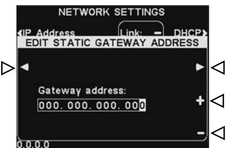
ゲートウェイアドレス編集をするには、Gateway address(ゲートウェイアドレス)ボタンを押し、EDIT STATIC GATEWAY ADDRESS(静的ゲートウェイアドレスの編集)画面で、◀(左)または▶(右)ボタンを使用し、変更したい数字にハイライトを移動し、+(アップ)と-(ダウン)ボタンを使用し希望の数字を入力します。
