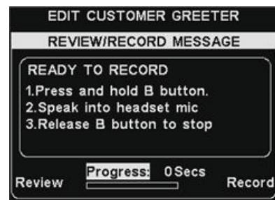
画面の **READY TO RECORD**(録音の準備)の指示に従います。ヘッドセットの B ボタンに触れ続けると、最高 16 秒間のメッセージを録音できます。**Progress**(プログレス)インジケーターが録音の残り時間を示します。録音を終了するときは、B ボタンを離し、画面の **Review**(確認)ボタンを押し、**READY TO REVIEW**(確認の準備)画面の指示に従い、録音が正しく行われたかを確認します。
