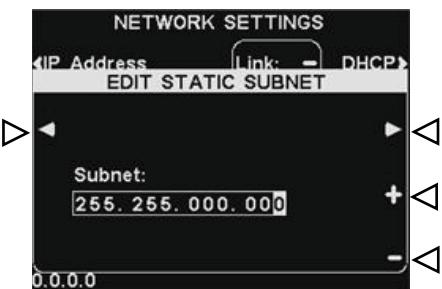
この設定をするには、Subnet(サブネット)ボタンを押し、EDIT STATIC IP SUBNET(静的サブネットの編集)画面で、◀(左)または▶(右)ボタンを使用し、変更したい数字にハイライトを移動し、+(アップ)と-(ダウン)ボタンを使用し希望の数字を入力します。
