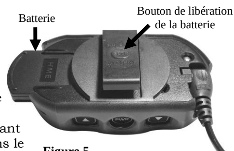
Figure 5. Bouton de libération de la batterie d'un ceinture-pac
