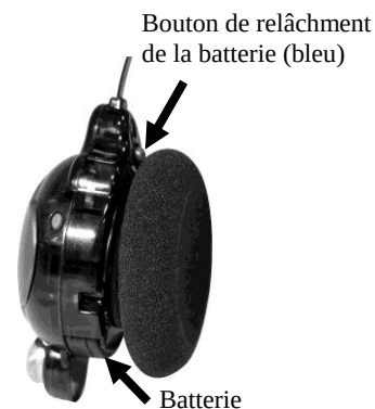
Figure 6. Bouton de relâchement de la batterie du casque
