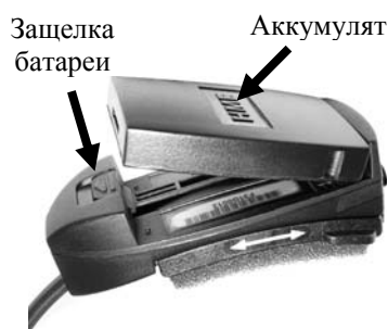
Рис. 7. Защелка батареи на гарнитуре
