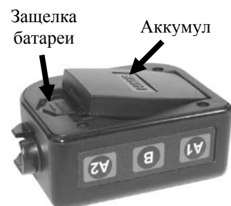
Рис. 6. Защелка батареи на поясном коммуникаторе
