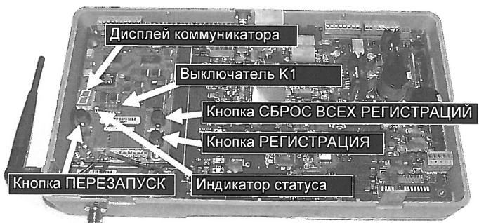
Рисунок 4. Кнопки регистрации и индикаторы в базовой станции
