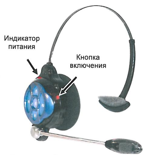
Рисунок 1. Кнопка включения и индикатор питания гарнитуры
