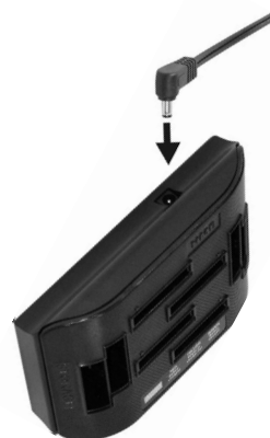
Рисунок 6. Вставьте шнур адаптера в корпус станции AC50
