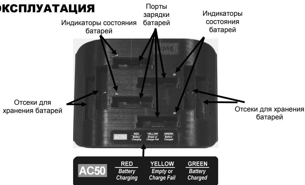
**Рисунок 9. Порты и индикационное оборудование, отображающее состояние элементов питания, на передней панели станции AC50**
