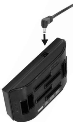
Рисунок 6. Вставьте шнур адаптера в корпус станции AC50
