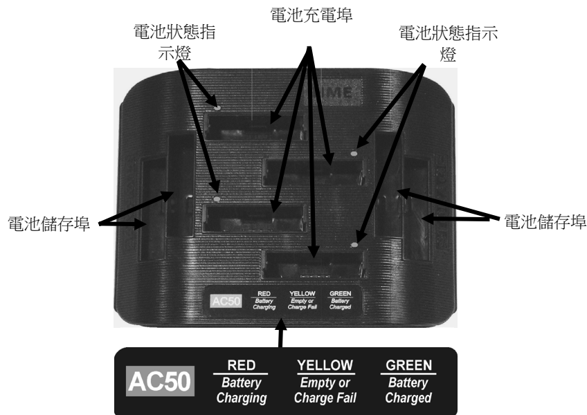
圖 9.AC50 前面板功能和電池狀態指南
