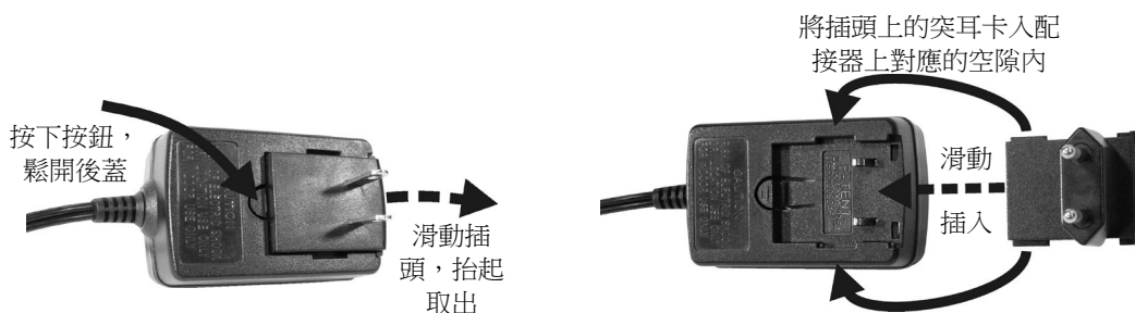
圖 8.變換國際電源配接器上的插頭
